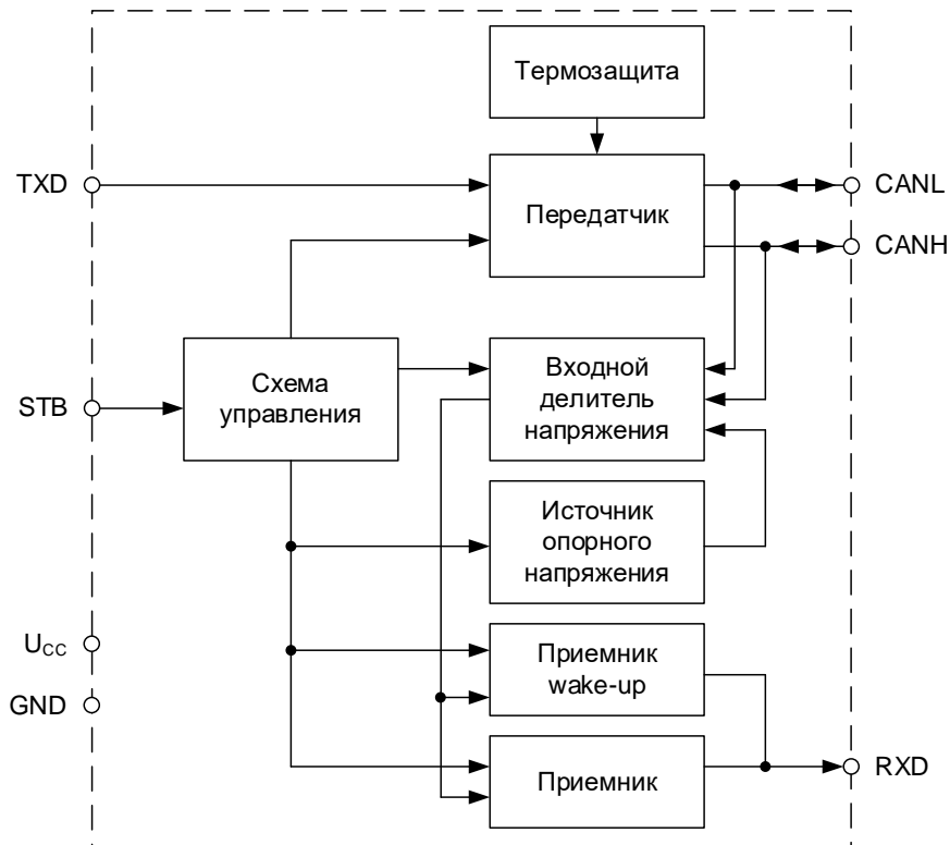
Рисунок 1 – Структурная блок-схема микросхем MDR3108FI
