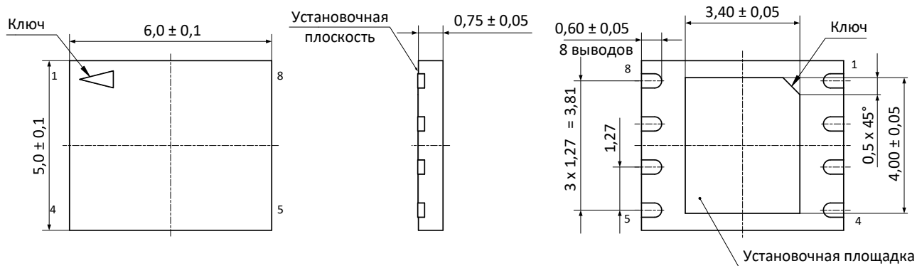
Рисунок 11 – Микросхема в корпусе DFN8 5×6×0,75 (1,27)
